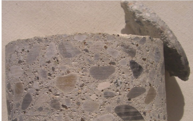
Foto 4. massa volumica della carota saturata: 2183 kg/m 3 per evidente inglobamento d'aria
