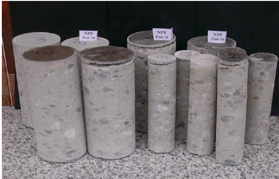
Foto 6. Carote provenienti dal padiglione di polo fieristico- Massa volumica satura media: 2.189,5 kg/m 3 - Resistenze medie in opera: 17,0 MPa
